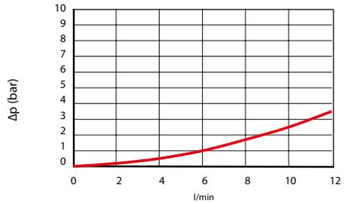
Olio idraulico minerale 32 cSt – temp. 40 °C [104 °F]
